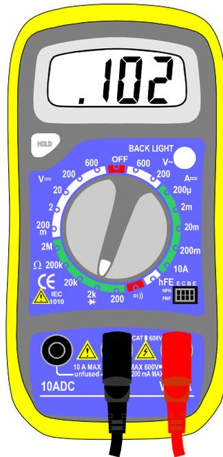
*L'afficheur indique 0,102 k $\Omega$  (soit 102  $\Omega$ ), le calibre immédiatement inférieur est de 200  $\Omega$ .
