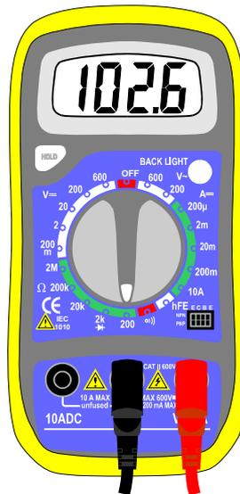
*Le sélecteur de calibre a été placé sur le calibre 200  $\Omega$ .
