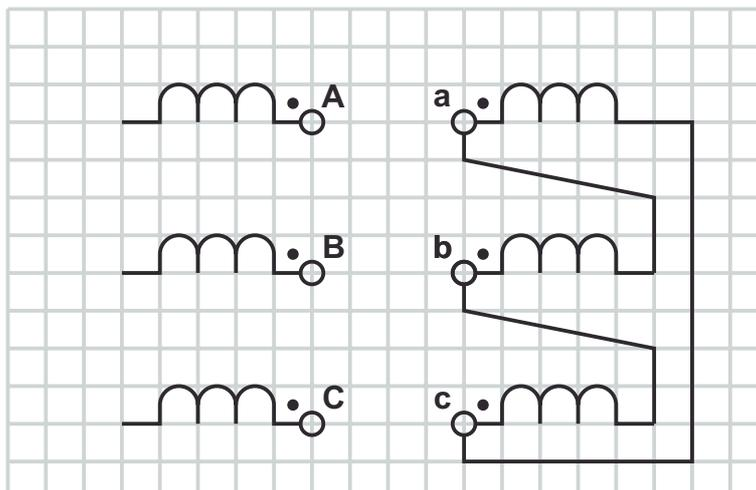
En prenant comme référence la tension  $V_{AN}$  (tension simple entre la phase raccordée à la borne A et le point commun des trois enroulements du primaire), complétez le diagramme vectoriel des tensions simples primaires et tensions simples secondaires du transformateur précédent.
